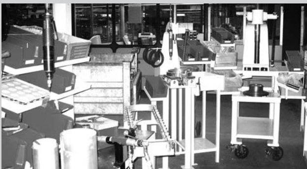
Montagelinie mit den in U-Form angeordneten Arbeitsplätzen
