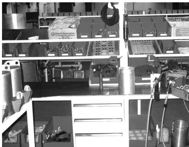
Arbeitsplatzgestaltung mit Werkzeug und Material im Arbeitsraum des Mitarbeiters
